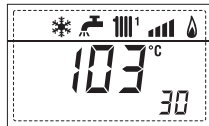
31. Visualización valor de la temperatura de la sonda solar S2 con tarjeta solar INSOL
