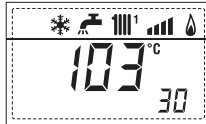
31. Visualização valor da temperatura da sonda solar S12 com placa solar INSOL
