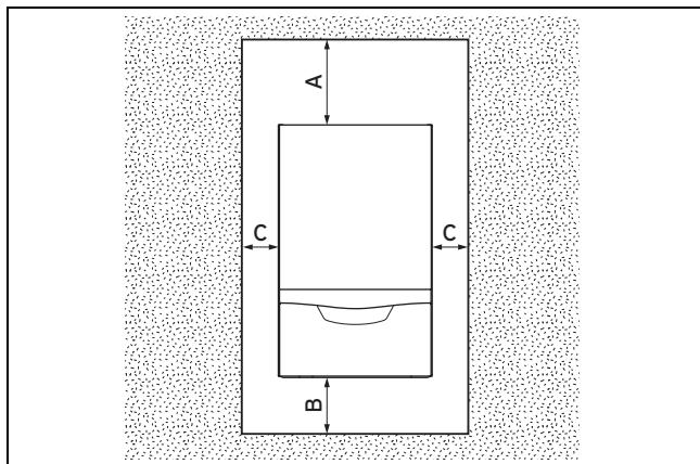
A 350 мм (система дымоходов/воздуховодов Ø 110/160 мм)
