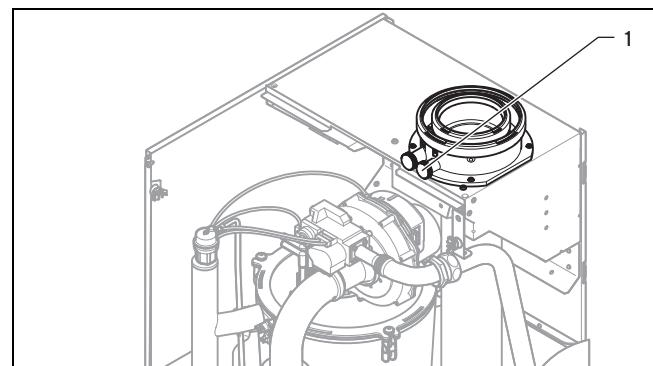
3. Измерьте содержание CO<sub>2</sub> и CO на измерительном патрубке отходящих газов (1).
