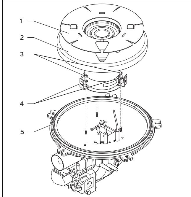
1. Проверьте поверхность горелки на наличие повреждений. Обнаружив повреждения, замените горелку в сборе с уплотнением, см. „Замена горелки (→ страница 34)“.
