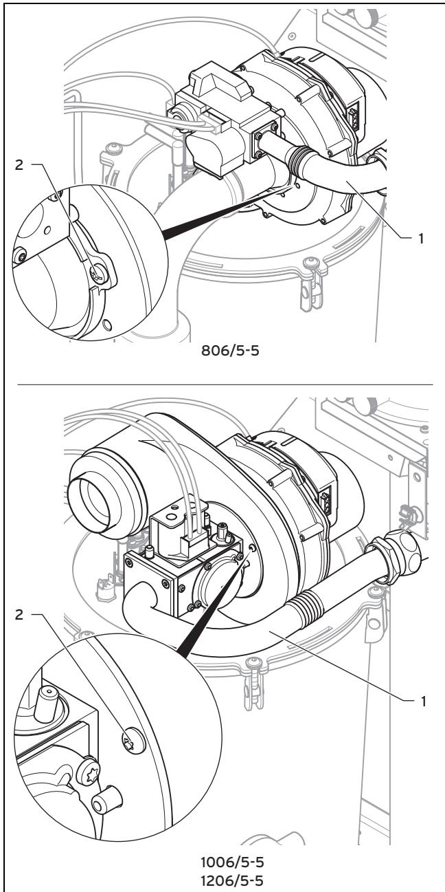
1. Демонтируйте газовую трубу (1) с газовой арматурой.
