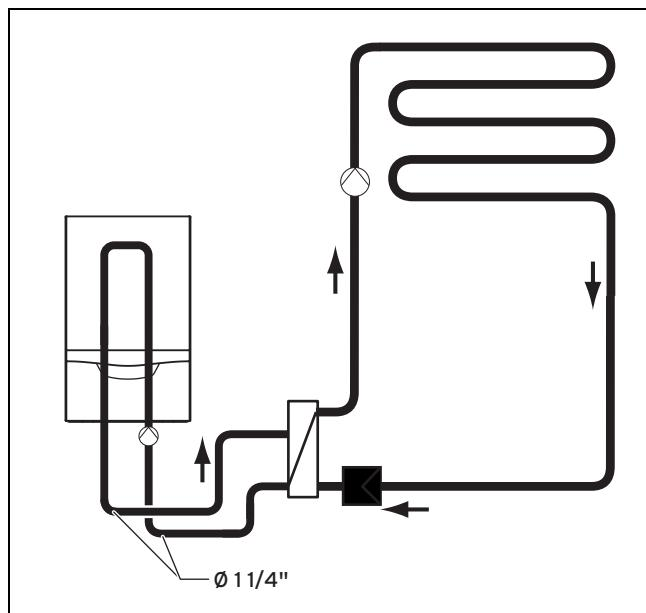
При соединении с системой отопления для гидравлического разделения системы используйте только пластинчатый теплообменник. Дополнительно со стороны системы рекомендуется установить грязевой фильтр перед пластинчатым теплообменником. Для техобслуживания пластинчатого теплообменника со стороны системы отопления рекомендуется установить промывочные патрубки, используемые для обратной промывки пластинчатого теплообменника.
