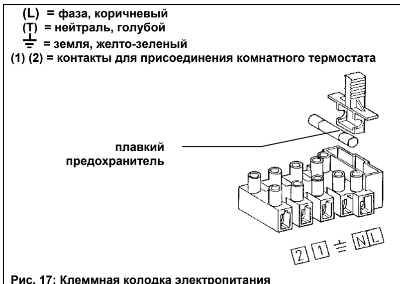
Рис. 17: Клеммная колодка электропитания
