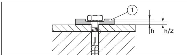
4. Закрепите основание оголовка шахты четырьмя винтами на краю устья.
