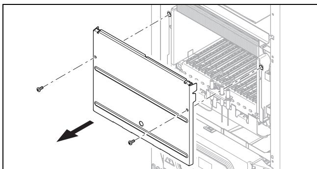
► Снимите крышку камеры сгорания, как показано на рисунке.
