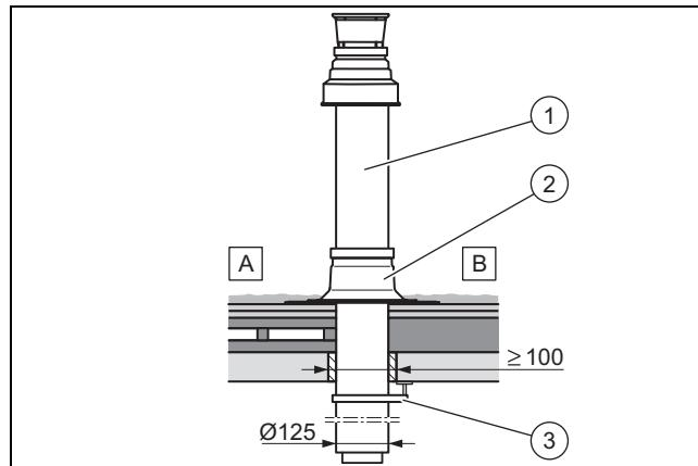
A Неутепленная крыша      B Утепленная крыша
