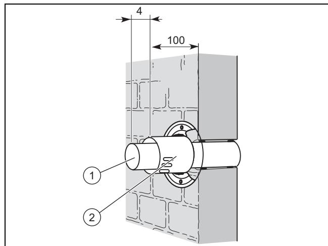
1. Просверлите отверстие для дымохода 60 мм в вертикальной части дымохода.
