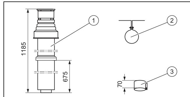
1 Вертикальный проход через крышу      2 Крепежный хомут      3 Хомут 70 мм
