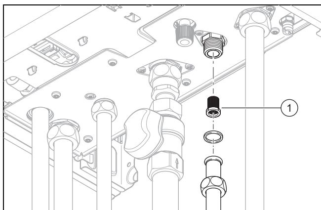
1. Очистите прибор со стороны горячей воды, открутив резьбовые соединения на трубопроводе горячей воды.
