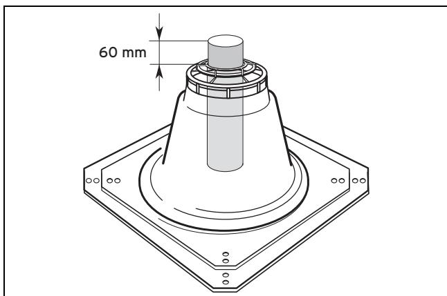
8. Проконтролируйте, чтобы над основанием оголовка шахты выступало 60 мм.
