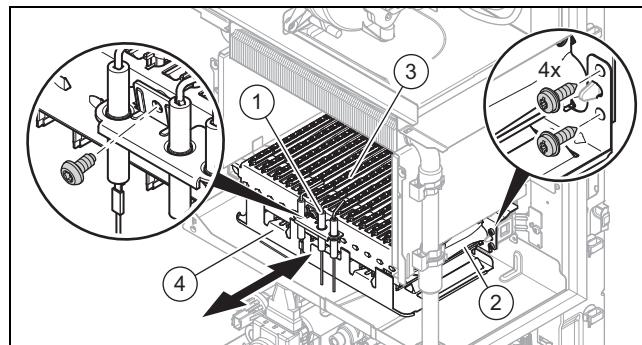
1. Открутите винты на газораспределительной трубе (2).
