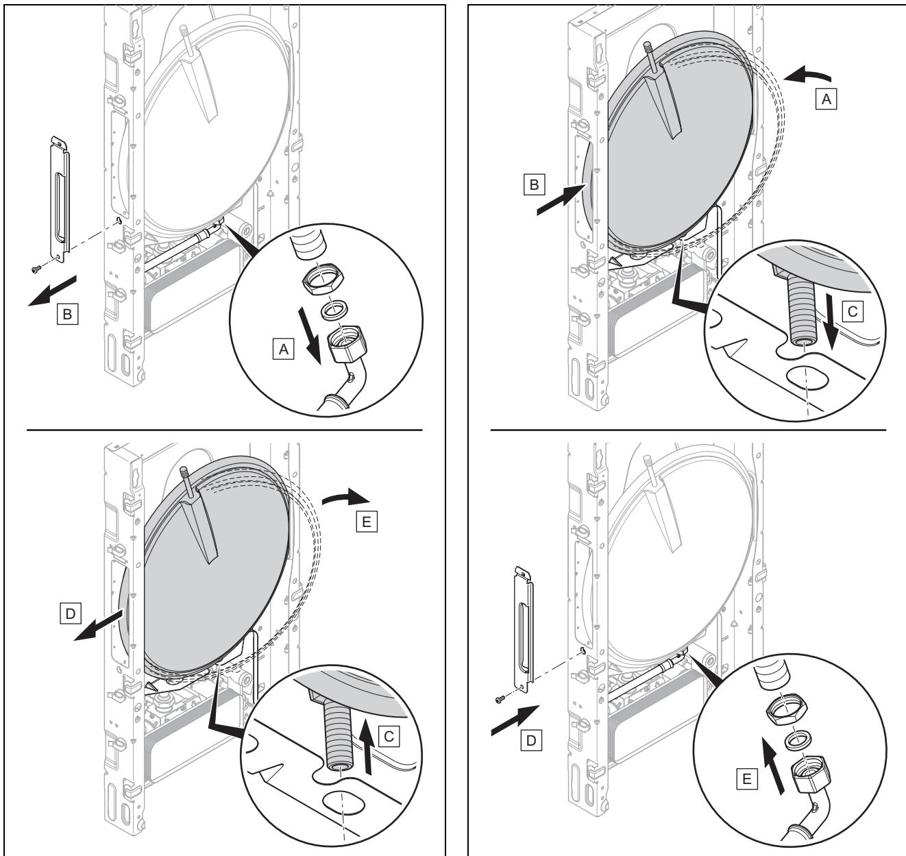
5. Снимите расширительный бак, как показано на рисунке.
