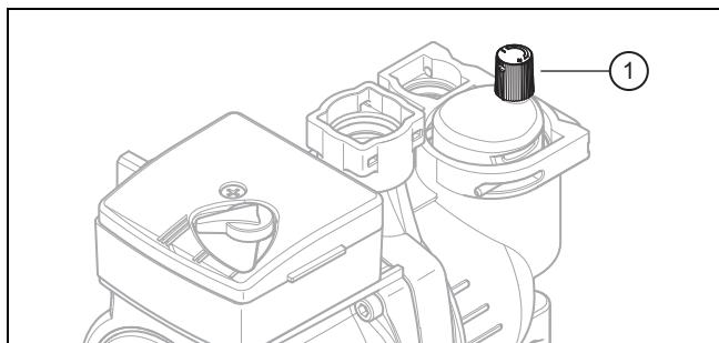
4. Снимите колпачок (1) быстродействующего воздухоотводчика.
