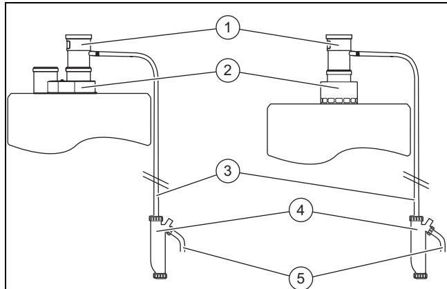
4. Вставьте отвод конденсата (1) в присоединительный элемент (2).
