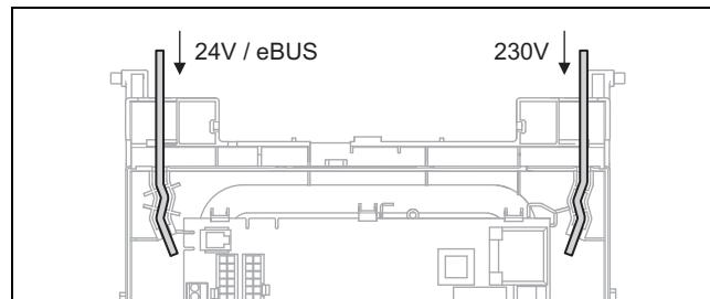
1. Проведите присоединительную проводку подсоединяемых компонентов через кабельный ввод слева и справа на нижней стороне блока электроники.
