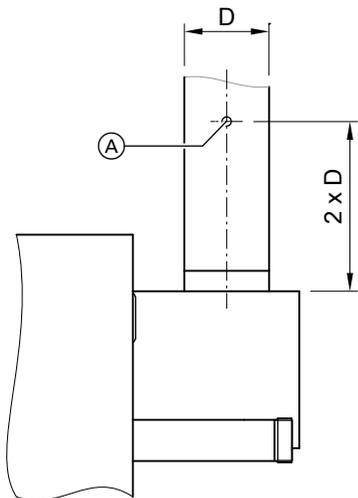
Ⓐ Измерительное отверстие  $\varnothing$  10 мм
