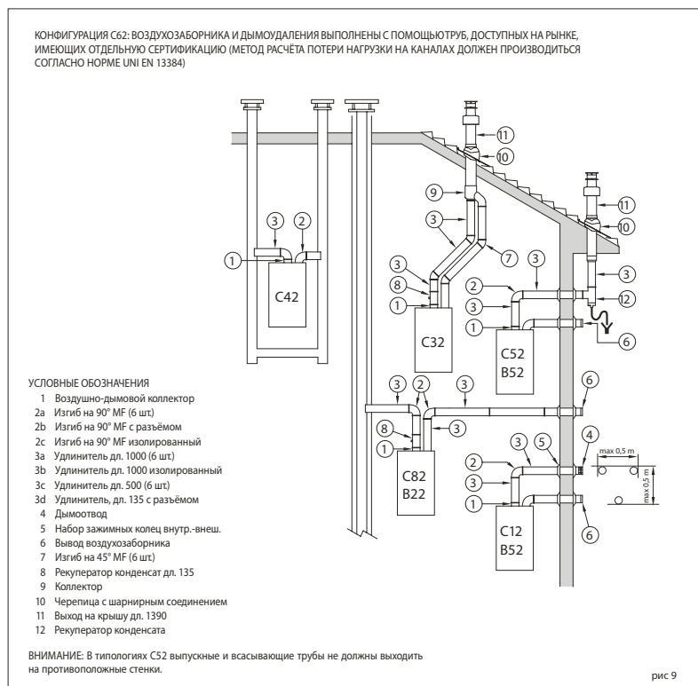
Схемы на рис. 9 показывают некоторые примеры разных типов отдельных режимов выпуска.
