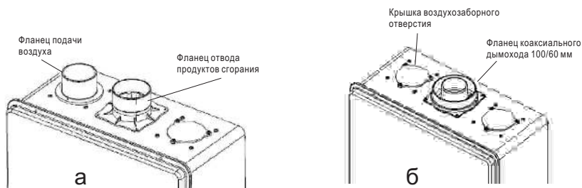
Рис. 1. Внешний вид фланцев котла Arderia:
