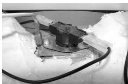
Рис. 26: Кнопка включения предохранительного термостата
