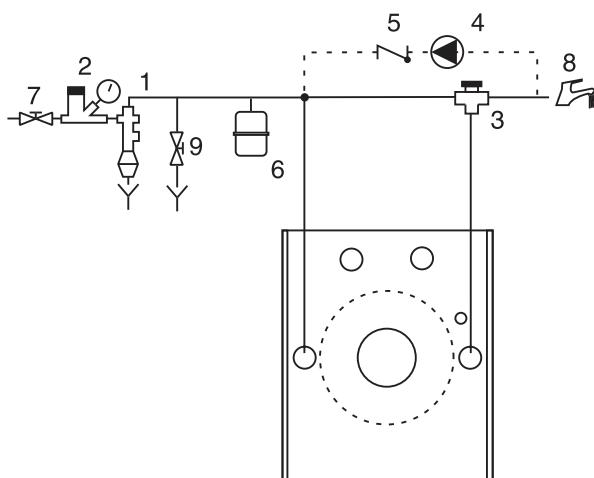
Рис. 5b: Схема с термостатическим смесителем
