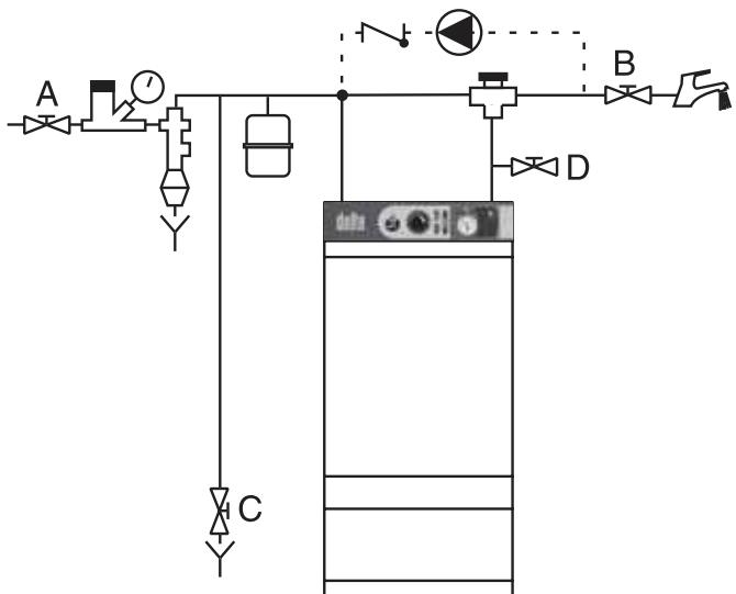
Рис. 13б: Слив контура горячего водоснабжения
