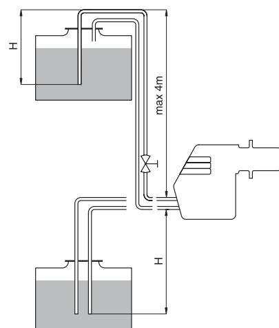
Рис. 8b: Питание топливом с обратной магистралью при высоком или низко расположенному баке
