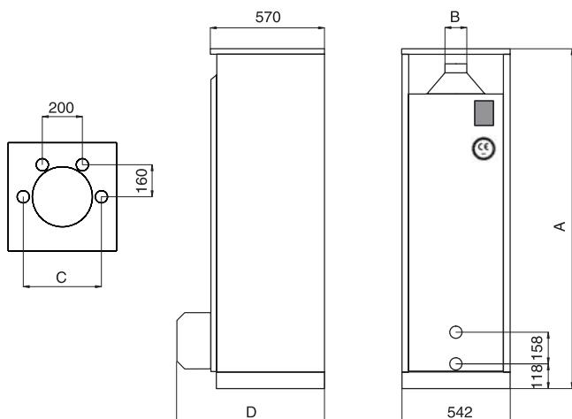
Рис. 18: Габаритные размеры
