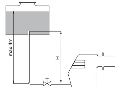
Рис. 8a: Схема без терmostатического смесителя.
