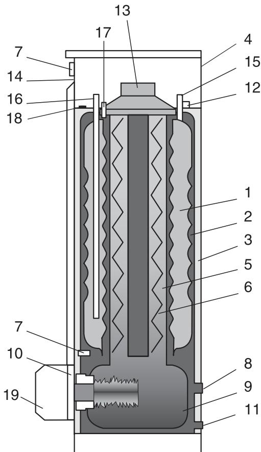
Рис. 16: Устройство котла
