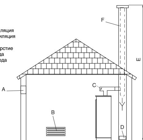
Рис. 1: Вентиляция котельного помещения и присоединение дымохода
