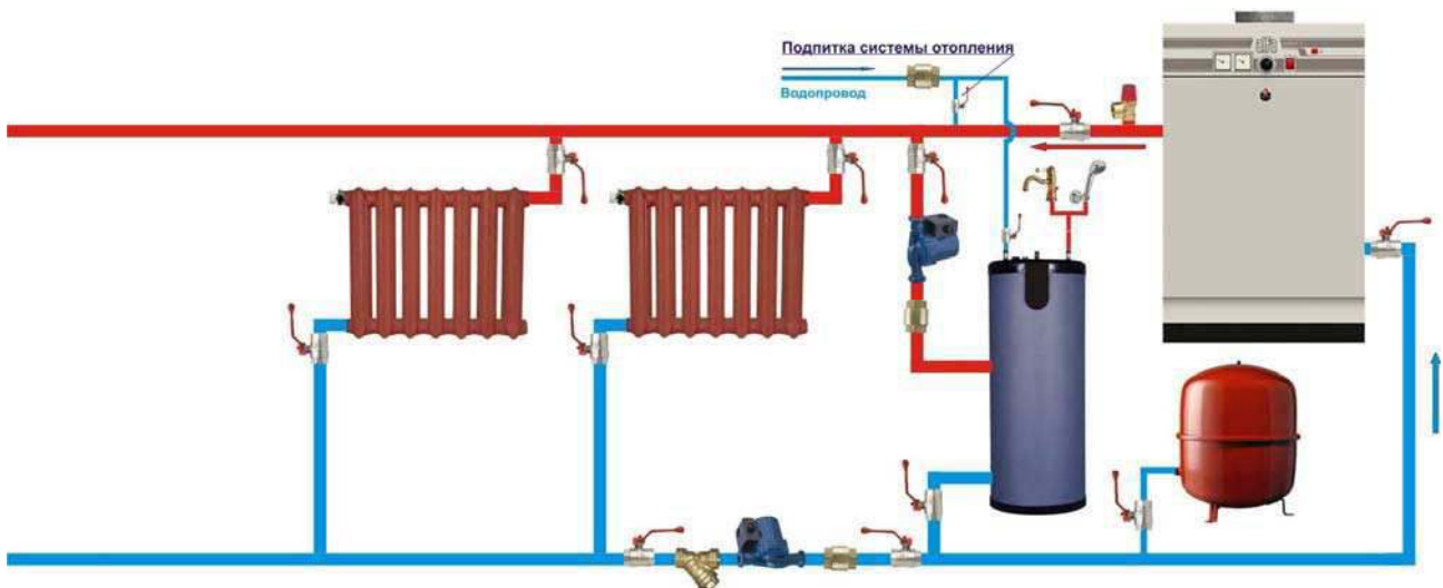
Рисунок 6. Схема подключения котла с общим коллектором.
