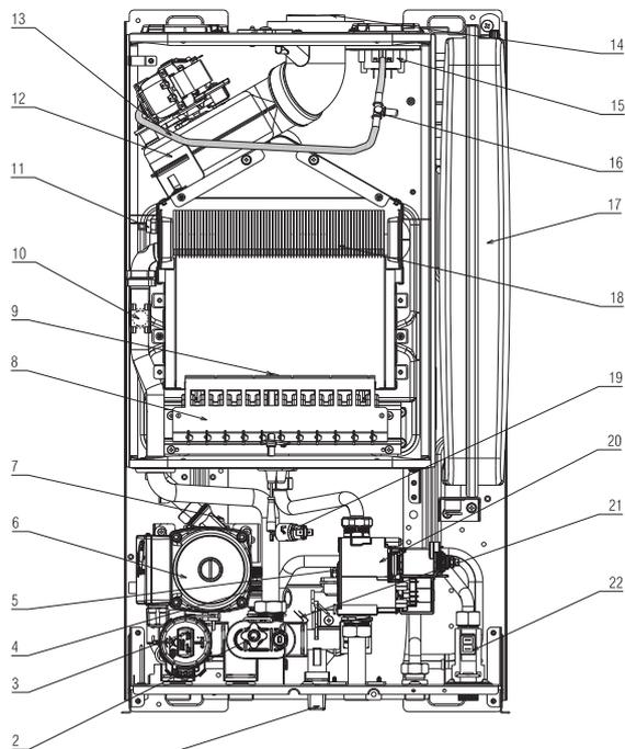
11 Датчик NTC контура отопления
