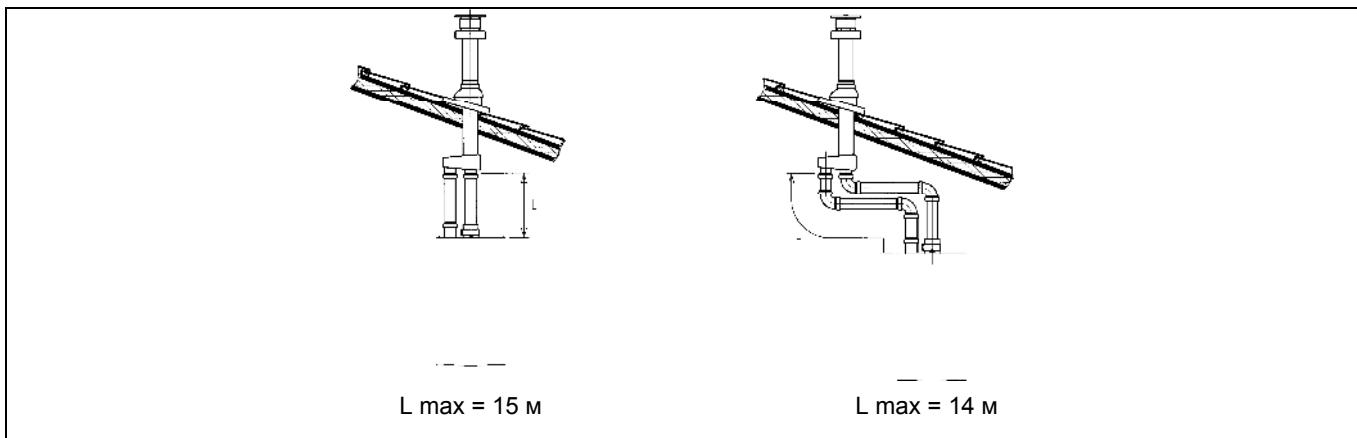
**Обратите внимание!** При установке дымохода убедитесь, что труба хорошо изолирована (напр., стекловолокном) в месте прохода трубы сквозь стену здания.
