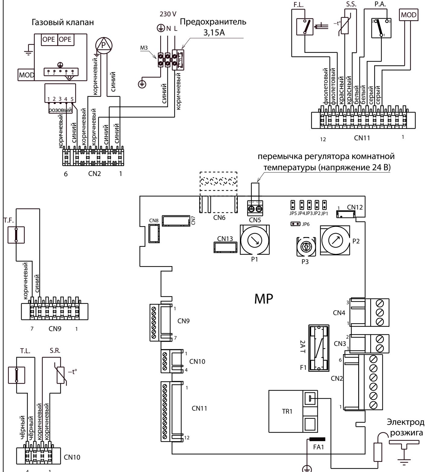
**MR** Плата управления со встроенным ЖК-дисплеем и трансформатором розжига
