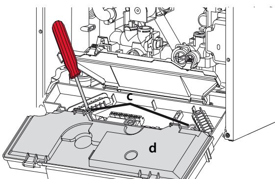
Доступ к электронному блоку (см. рисунок) обеспечивает подключение таких устройств:
