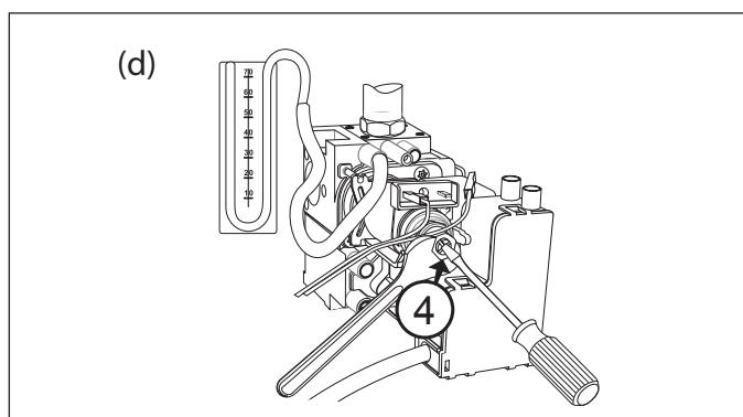
5. Подключите провод к регулятору давления.
