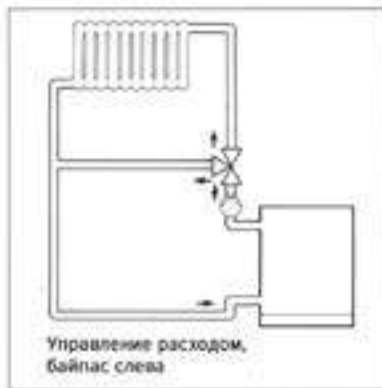
Смесительное регулирование, подмешивание слева
