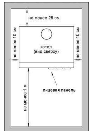
Рисунок 5 – Схема установки котла
