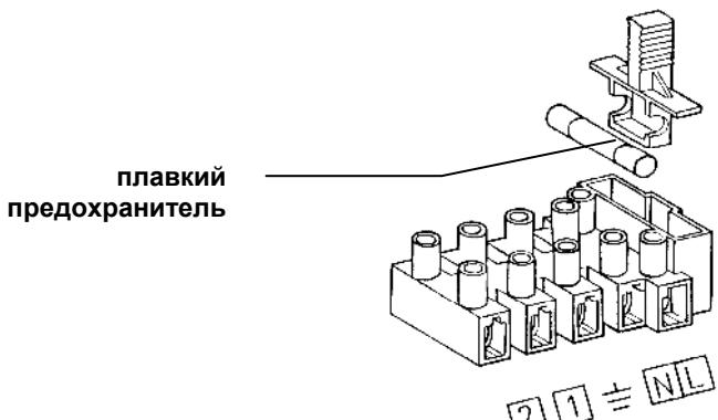
Рис. 17: Клеммная колодка электропитания
