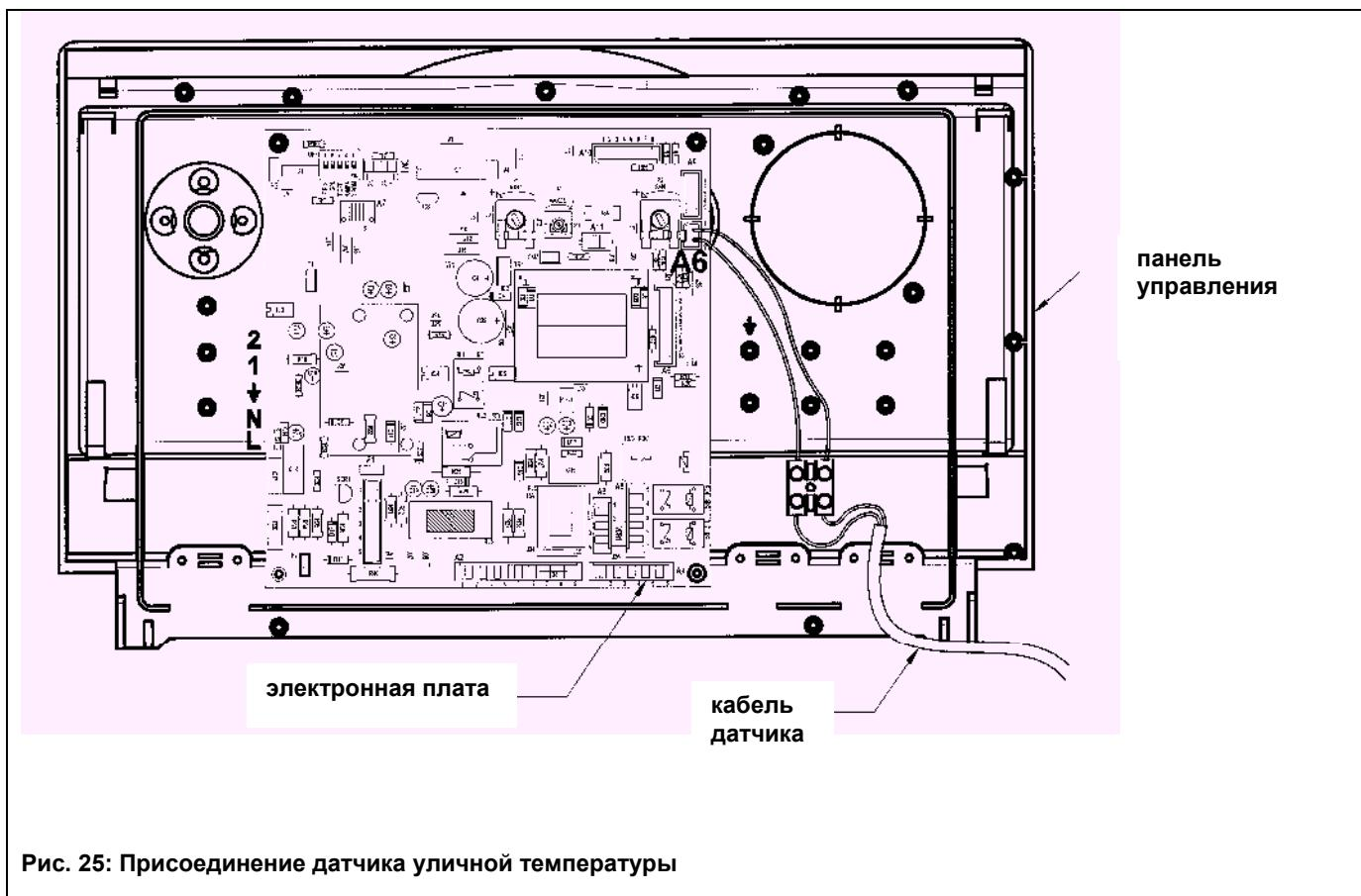
Рис. 25: Присоединение датчика уличной температуры
