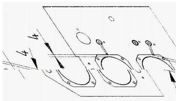
Рис. 32 Расположение электродов зажигания
