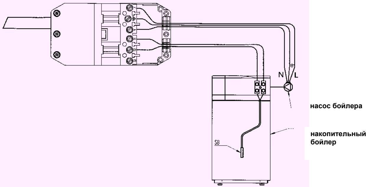
Рис. 24: Электрическое присоединение для бойлера Slim UB 80-120 INOX
