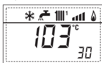
31. Визуализация значения температуры солнечного датчика с солнечной схемой
