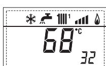
33. Визуализация солнечного реле R1 с солнечной схемой (соответственно ВКЛ. и ВЫКЛ.)
