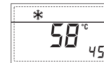
61. Визуализация кода ошибки предпоследней неисправности
