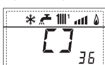
40. Визуализация % значения механизма управления насосом PWM
