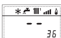
45. Визуализация температуры контура отопления, соответствующей третьему контуру
