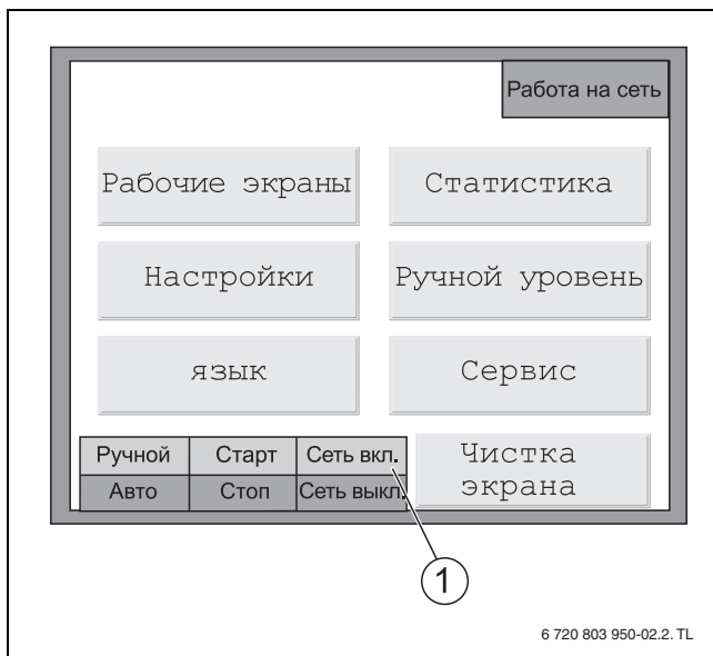
Рис. 32 Включение силового реле генератора
