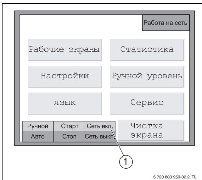
Рис. 8 Включение силового реле генератора
