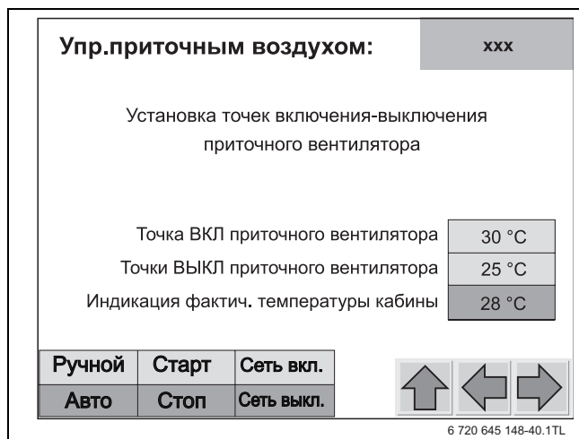
Рис. 27 Экран настройки „Управление приточным воздухом“
