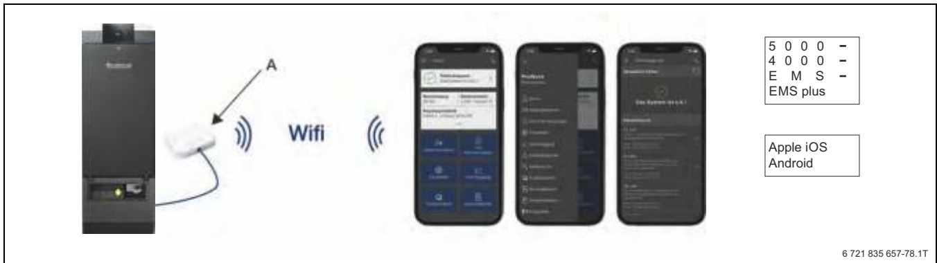
Рис. 37 Logamatic Smart Service Key и приложение ProWork
