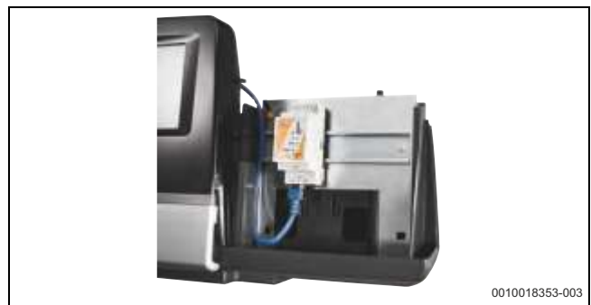
Рис. 49 IP-шлюз Control Centre CommercialPLUS (монтируется на модуле FM-RM с верхней крышкой, принадлежность)
