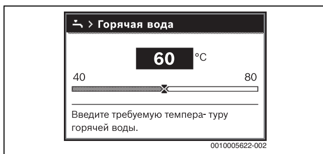
Рис. 9 Установка максимальной температуры горячей воды
