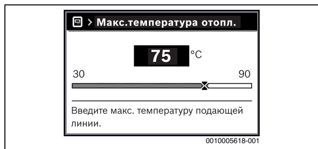
Рис. 7 Установка максимальной температуры подающей линии
