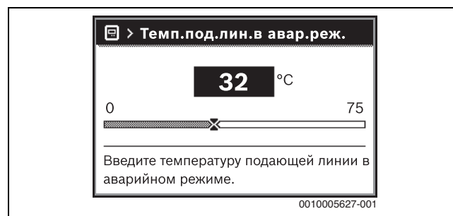
Рис. 10 Температура подающей линии для аварийного режима
