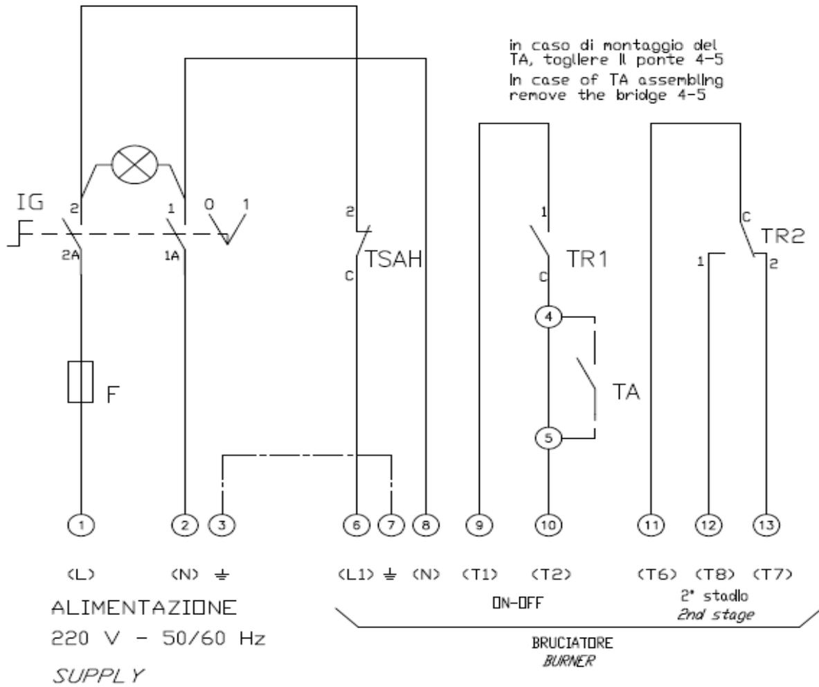
In caso di bruciatore con solo cavo tripolare, eseguire i collegamenti sotto indicati
