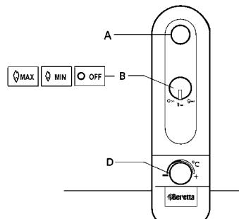
Рис.8-1 Передняя панель моделей с пьезорозжигом
