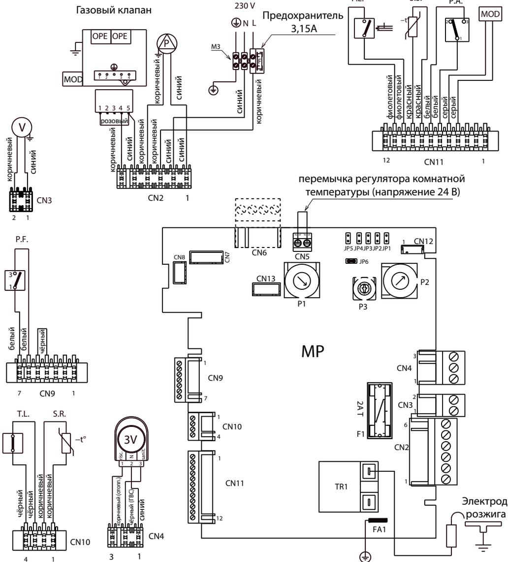
MP Плата управления со встроенным ЖК-дисплеем и трансформатором розжига
