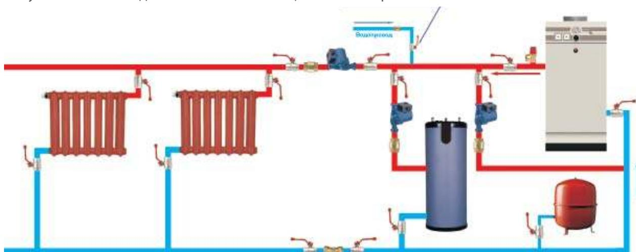
Рисунок 7. Схема подключения котла с принудительной циркуляцией теплоносителя.
