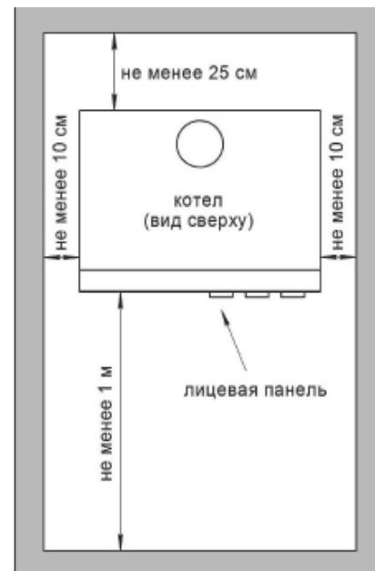
Рис. 5 – Схема установки котла
