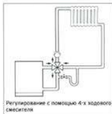
Устройство гидрозатвора в схеме со смесительным регулированием
