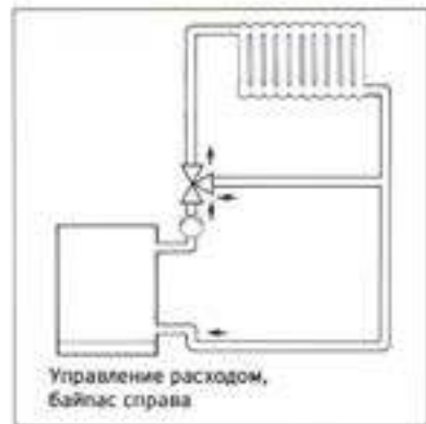
Смесительное регулирование, подмешивание справа
