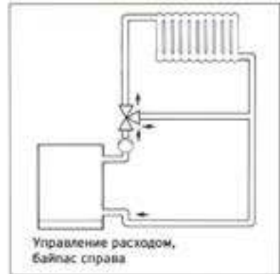
Смесительное регулирование, подмешивание справа
