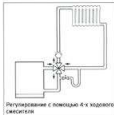
Устройство гидрозатвора в схеме со смесительным регулированием
