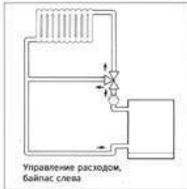
Смесительное регулирование, подмешивание слева
