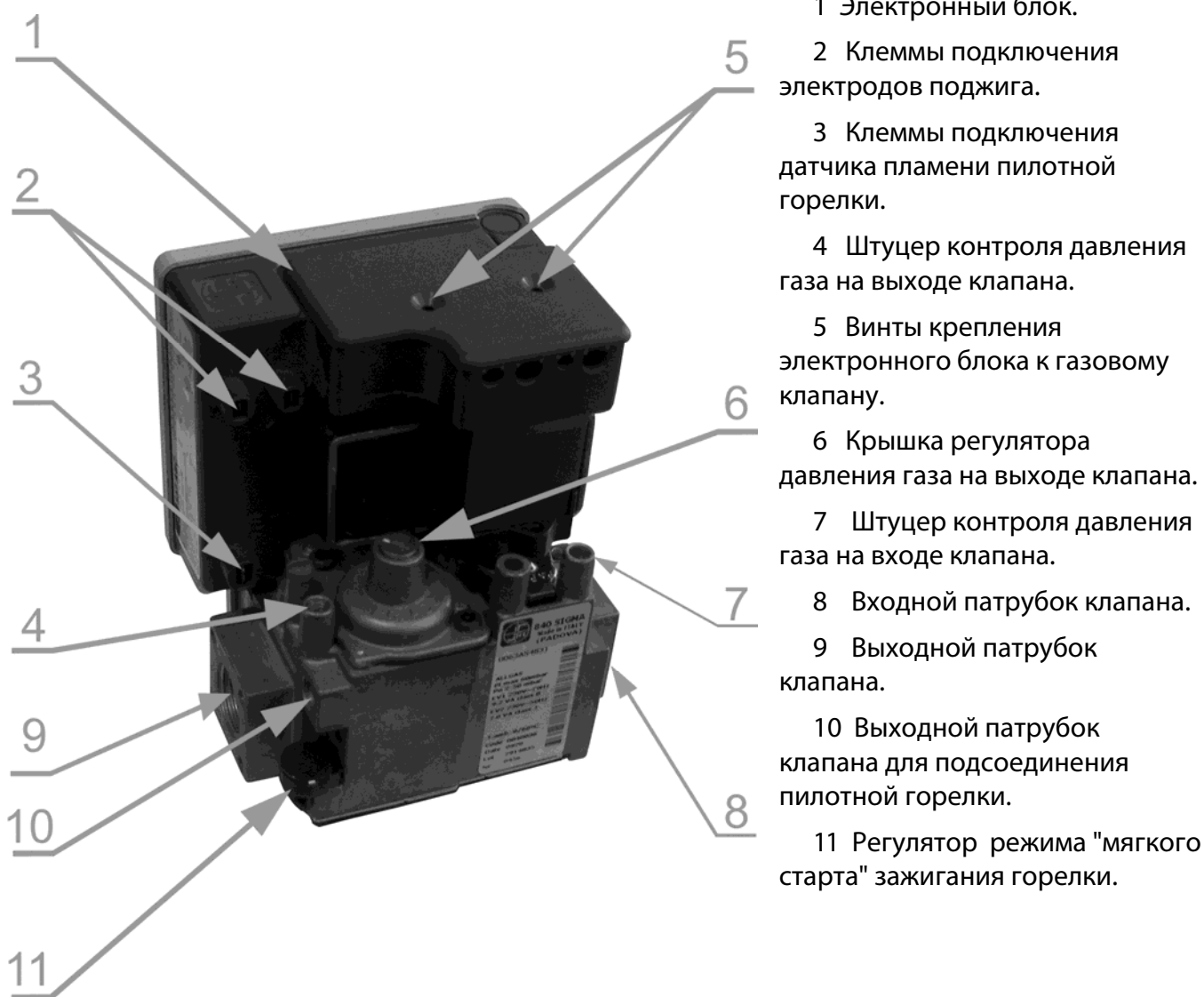
Рисунок 11. Газовый клапан котла с автоматикой.
