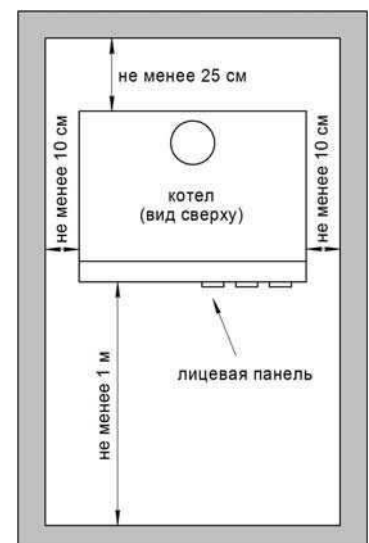
Рисунок 5 – Схема установки котла
