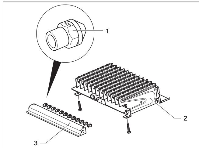
Рис. 6.4 Маркировка сопла
