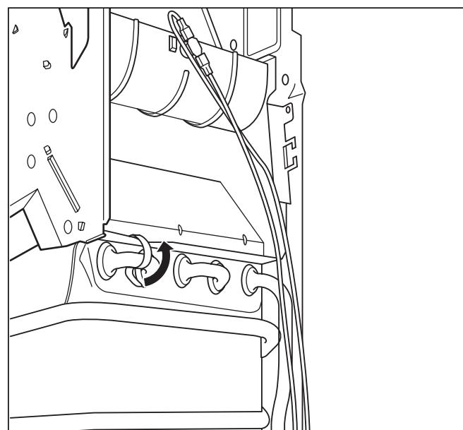
Рис. 7.8 Демонтаж теплообменника
