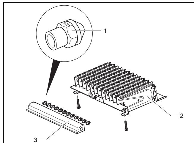
Рис. 6.8 Маркировка сопла
