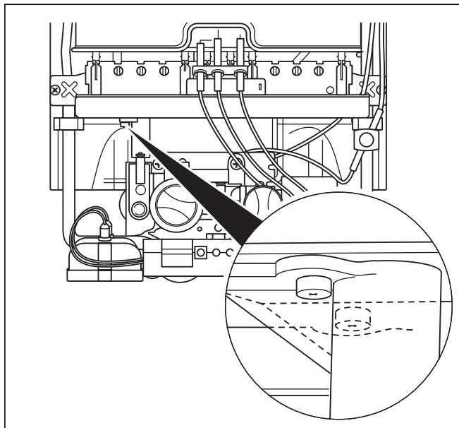
Рис. 7.3 Крепление горелки на газовой арматуре, тип RXI
