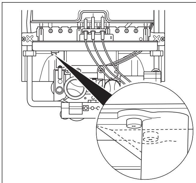
Рис. 7.4 Крепление горелки на газовой арматуре, тип GRX
