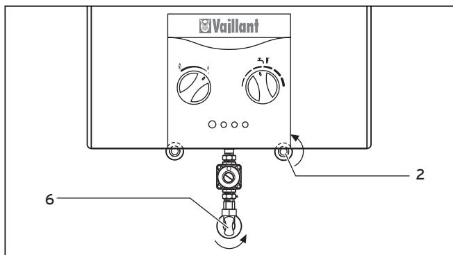
Рис. 4.3 Запорные устройства
