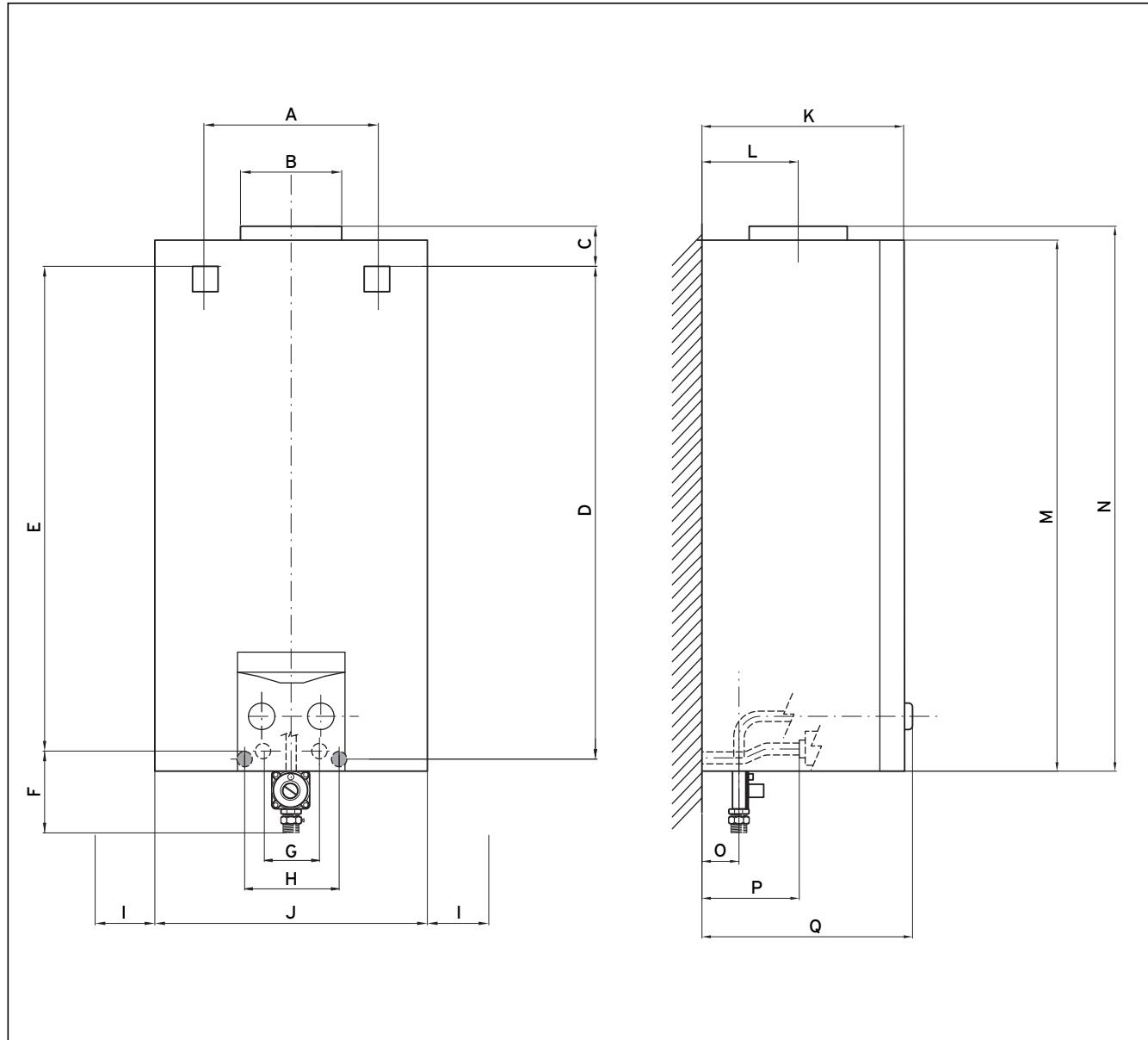
Рис. 4.4 Размеры водонагревателя
