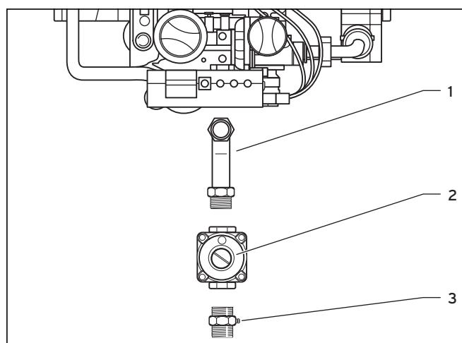
Рис. 4.2 Монтаж регулятора давления газа, тип GRX
