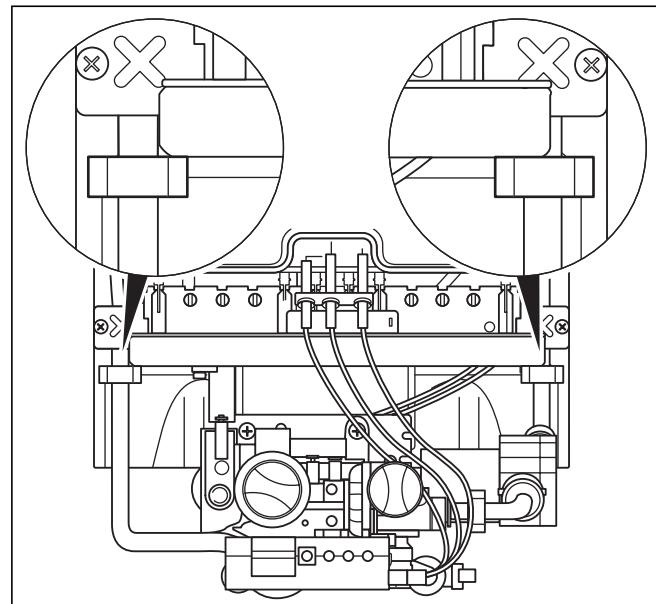
Рис. 7.7 Крепление задней стенки теплообменника, тип GRX
