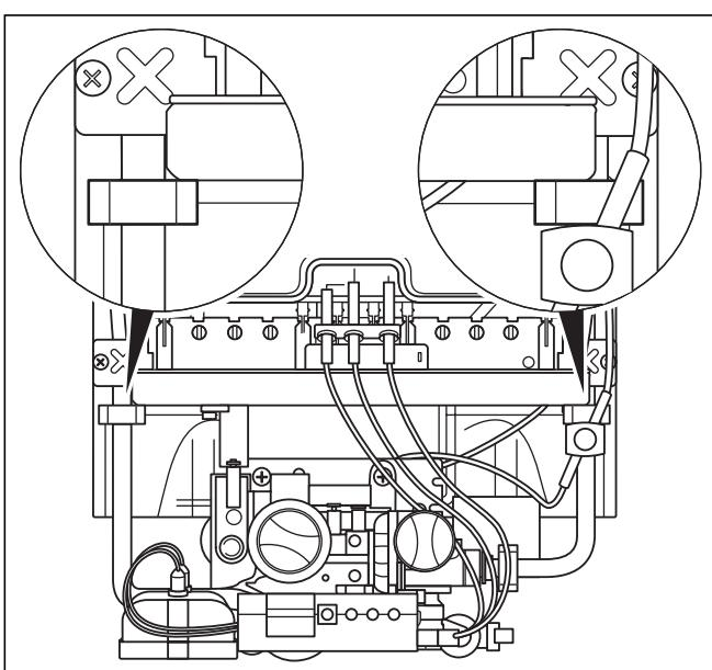
Рис. 7.6 Крепление задней стенки теплообменника, тип RXI
