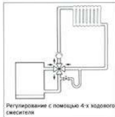
Устройство гидрозатвора в схеме со смесительным регулированием
