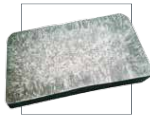
Слиток по технологии Raffmetal с использованием непрерывного литья
